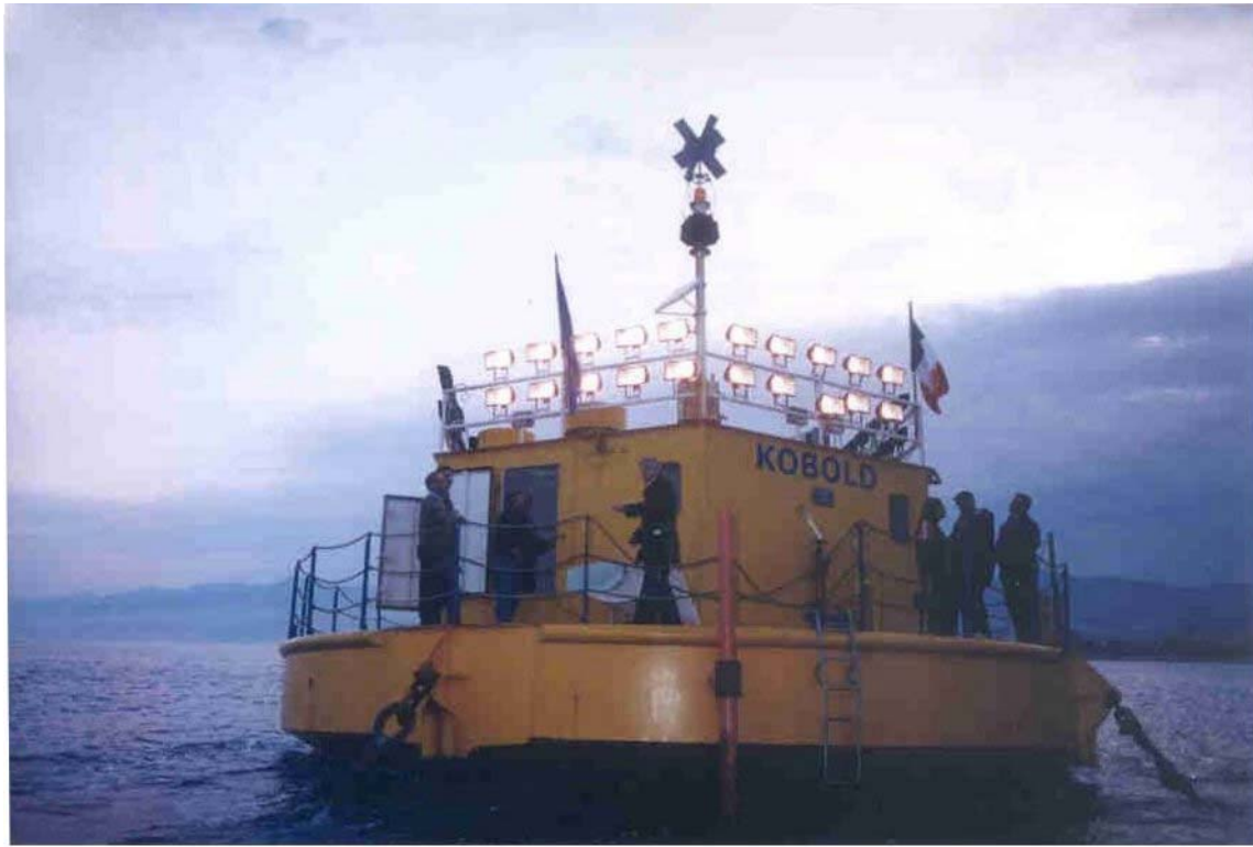
Fig. 18 La turbina Kobold mentre sta producendo energia elettrica accendendo le lampade (Potenza totale 20 Kw)
